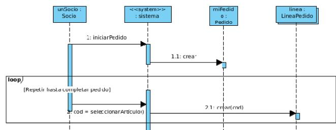
Por último destacar que se puede completar el diagrama añadiendo etiquetas y notas en el margen izquierdo que aclare la operación que se está realizando.
