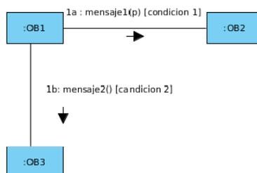
Cuando tenemos una condición se repite el número de secuencia y se añaden las condiciones necesarias, como vemos en la imagen según la condición se enviará el mensaje 1 o el 2, pero no ambos, por lo que coinciden en número de secuencia.
